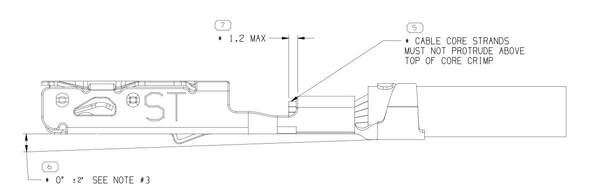
TERMINAL, CABLE ALIGNMENT & POSITION
